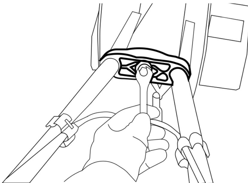
Используя крепежные болты, установите на раму мотокультиватора рукоятки управления.
