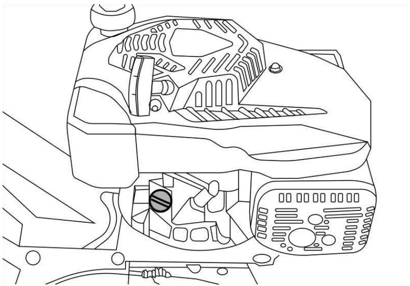
**ВНИМАНИЕ!** Во избежание попадания масла в камеру сгорания во время работы держите двигатель горизонтально. Наклоны двигателя свыше 10 градусов должны быть кратковременными.
