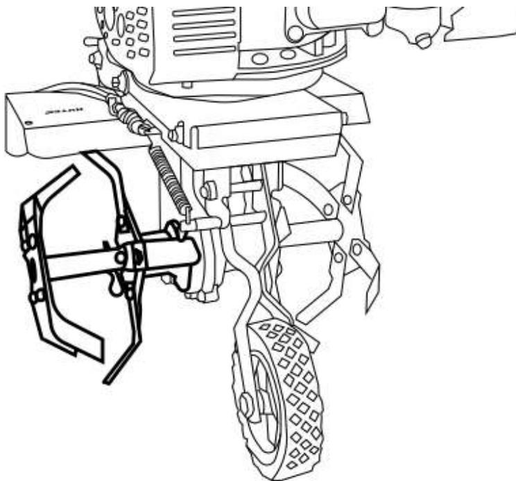
Установите сошник, используя для этого болт и гайку из комплекта (либо палец и шпильку). Сошник обеспечивает различную глубину обработки почвы. Правильная глубина культивации снизит рабочую нагрузку на механизмы. Выбор глубины культивации зависит от почвы, поэтому рекомендуется сделать вначале несколько пробных проходов, чтобы определить нужное положение сошника. После этого вы сможете оптимально обработать свой участок.
