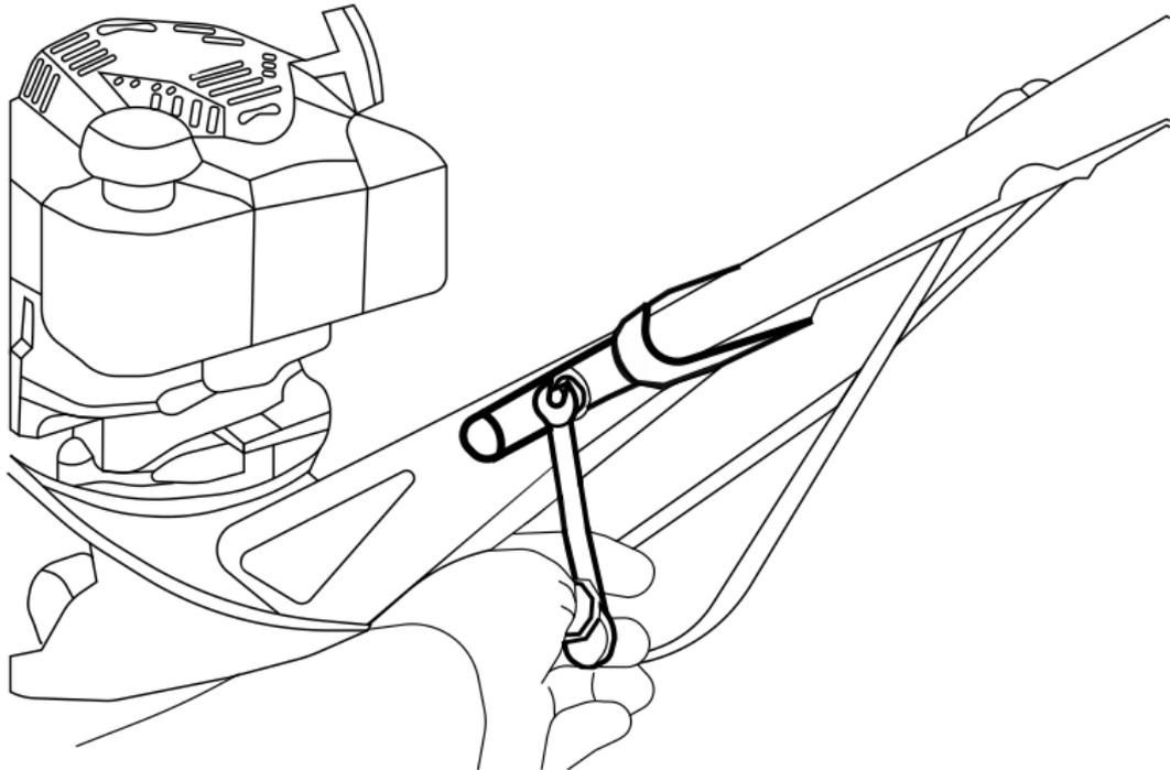
Установите рычаг газа на ручку управления при помощи болтов.
