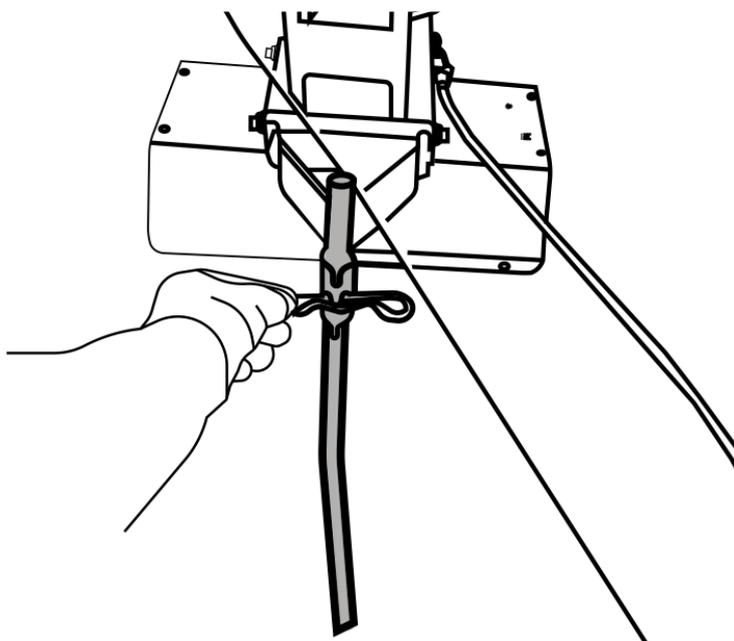
При необходимости перекачки мотокультиватора, установите опорное колесо на мотокультиватор.
