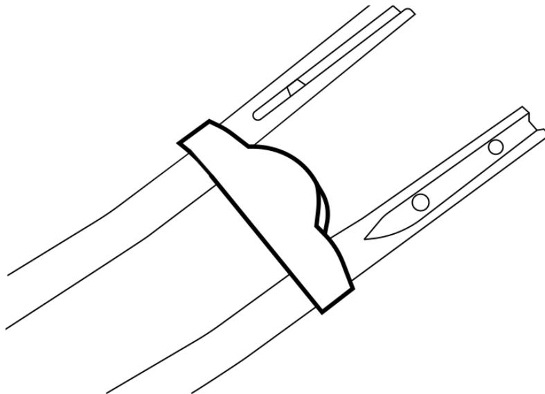
Закрепите пластиковый фиксатор рукояток управления на раму с помощью специального болта из комплекта.
